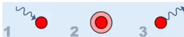
Abb. 1: Lichtreflexion an einer Oberfläche: Licht trifft auf ein Atom (1), das die Energie aufnimmt und dadurch angeregt wird (2), und die Energie danach wieder abgibt.
