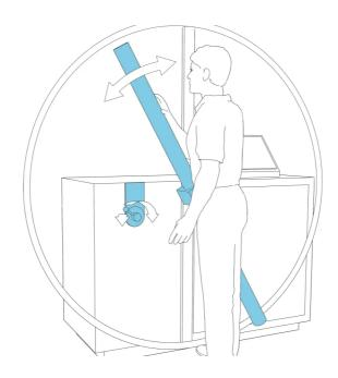
Stelle das Ventil auf "BELÜFTEN", um den Zylinder mit Luft zu füllen.
