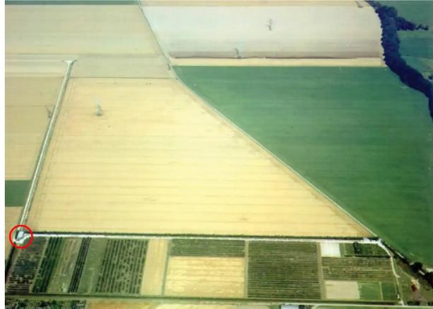
Abb. 3: GEO 600 bei Hannover aus der Luft. Deutlich zu erkennen: die beiden 600 m langen Arme für die Teilstrahlen des Interferometers. Der Rest des Interferometers mit Laser und Mess-Station befindet in dem Gebäude im roten Kreis.
