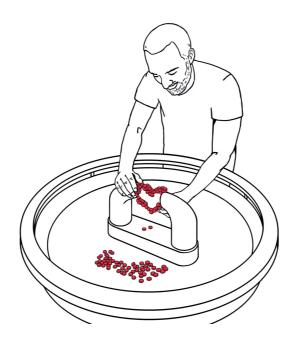
Bringe die Stahlscheibchen zwischen die zwei großen Magnetpole.
