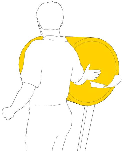
Schlage leicht auf die Mitte der Gummimembran der Luftkanone.
