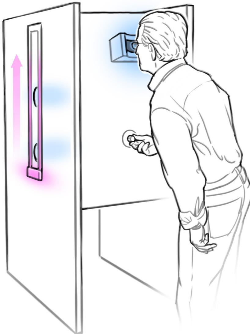
Das Prinzip ist einfach: Du blickst durch eine schräg gestellte, saubere Glasscheibe, die zugleich als Spiegel dient. Über einen zweiten, zur Glasscheibe parallel angeordneten Spiegel erscheint der zweifach gespiegelte „Geist“ am gewünschten Ort auf der Bühne.
