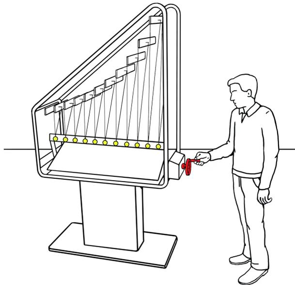
Drehe am Handrad, bis die Pendel ausgelöst werden und zu schwingen beginnen.
