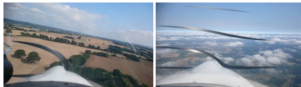
Abb. 1: Rolling-Shutter-Effekt: Der Propeller des Flugzeugs erscheint auf dem Foto in bizarren Formen, weil die Abtastfrequenz des Bildsensors entweder kleiner (links) oder größer (rechts) als die Anzahl der Drehungen des Propellers pro Sekunde ist. Dreht der Propeller im Landeanflug langsam, erscheint er auf dem Bild gebogen (links); dreht er im Reiseflug schneller, erscheint er als Striche im Bild (rechts) (Fotos: Torsten Klaffs).
